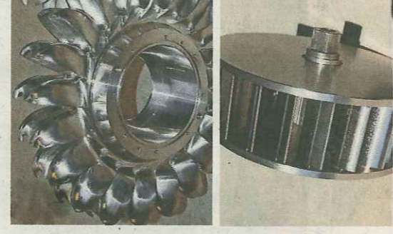
Eine Pelton-Turbine (oberes Bild) und die T-16-Durchströmturbine der Sigris AG. PD
