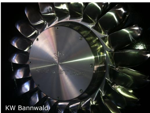
Das Herzstück jeder Anlage bildet ein perfekt abgestimmtes Turbinenlaufrad. Jedes Turbinenrad ist ein Einzelstück und wird mit modernsten CNC Maschinen angefertigt. Das Rad kann aus Einzelschaufeln bestehen oder „aus dem Vollen gefräst“ sein. Die Sigrist AG hat die notwendige Erfahrung und das Wissen, um solche technischen Bauteile herzustellen.
